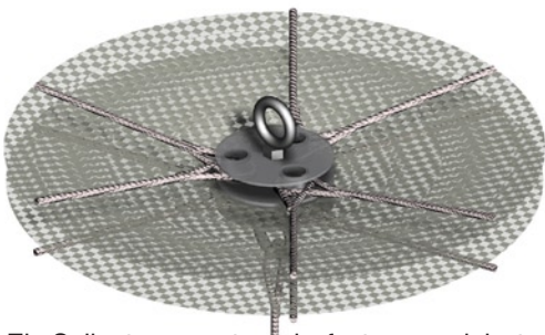
Ein Seilnetz aus extra reissfesten gespleisssten Dyneema Seilen, mit speziellen Klemmscheiben als Knotenpunkte hält die Pneuerelemente in Form, und nimmt die statischen Kräfte auf
